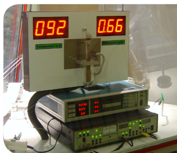
Pomiar temperatury przejścia fazowego oraz oporu elektrycznego nadprzewodnika, Graz, Austria. Fotografia: SRD
